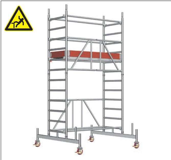
1. Zweites Grundgerüst 9 öffnen und Gelenk im Faltelement fest einrasten. Um 180° zum ersten Grundgerüst gedreht aufstecken. Die Stöße sind mit Federsteckern 15 zu sichern.
