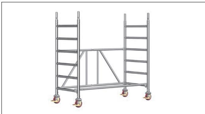
1. Das Grundgerüst 9 auseinanderziehen, Gelenke im Falteile fest einrasten und mit einer Rückenlehne 16 an der untersten Quersprosse aussteifen.
