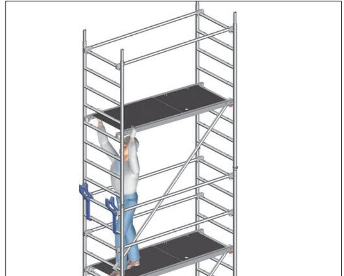
4. Diagonalen 19 und Durchstiegsbrücke 24 einsetzen. Die Diagonalführung ist den Gerüsttypen (Kapitel 4) zu entnehmen.
