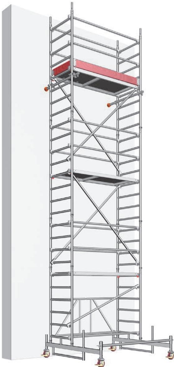
Für Arbeiten, die an einer tragfähigen Wand ausgeführt werden, kann die Ballastierung entsprechend der Tabelle **Ballastierung** (siehe Seite 8 – 10) reduziert werden. In diesem Fall sind an beiden Standleitern des Gerüsts Wandabstützungen oder Verankerungen einzubauen.
