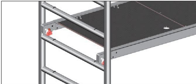
Die roten Schließbügel der Böden ermöglichen den mühelosen Ein- und Ausbau durch eine Person; sie sind zuerst zu lösen und der Belag mit den geöffneten Bügeln auf die Sprosse aufzulegen, dann erst werden die gegenüberliegenden Bügel gelöst und der Belag ausgehoben.
