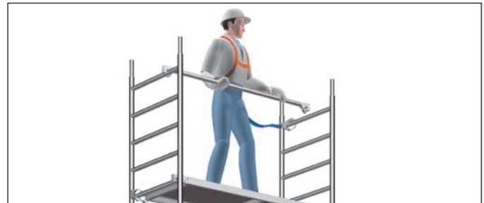
Bild 3: Sichere Montage der Rückenlehnen mit PSA
