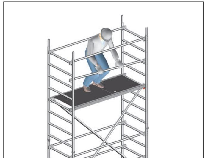
5. Auf die nächste Ebene aufsteigen und zusätzliche Rückenlehnen 16 an der zweiten Sprosse über der Standfläche montieren.
