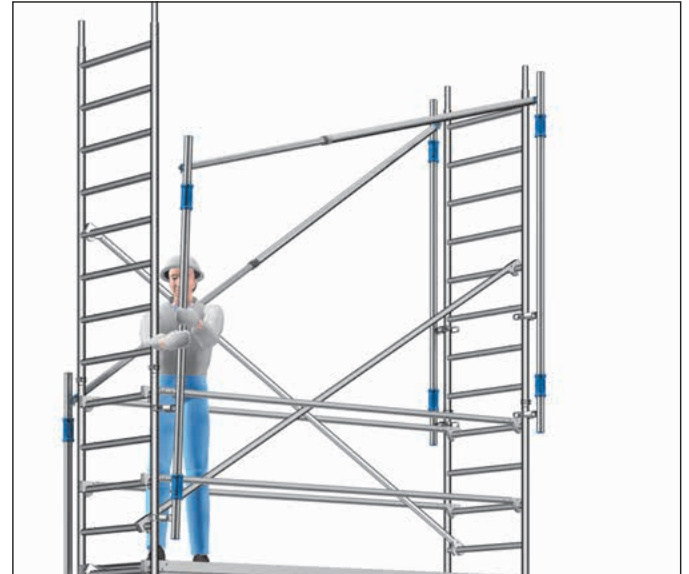
Bild 5: Versetzen des MSG nach oben
