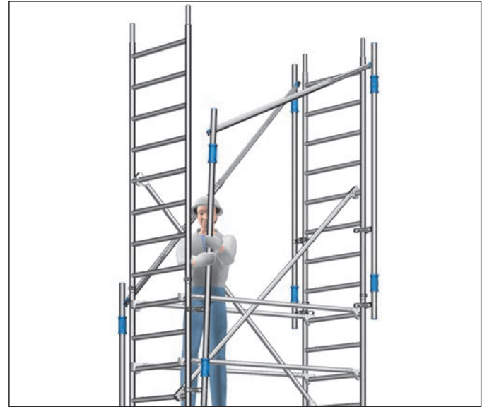
Bild 5: Versetzen des MSG nach oben
