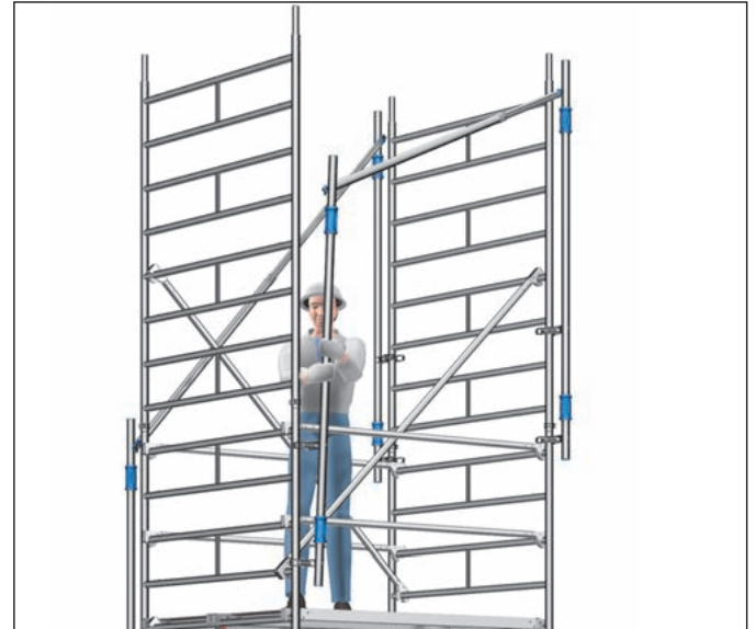
Bild 5: Versetzen des MSG nach oben
