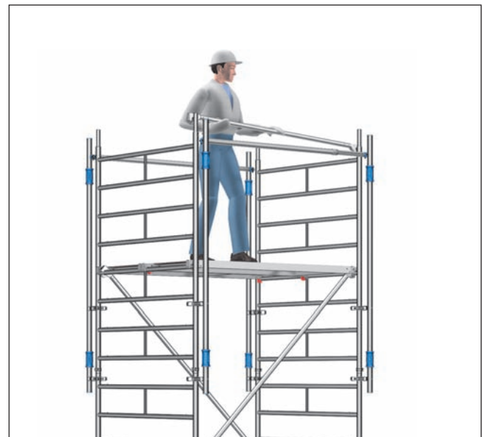
Bild 6: Sichere Montage der Rückenlehnen mit MSG
