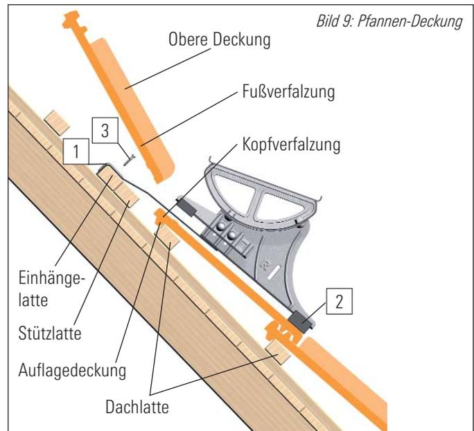
Die Kopfverfaltung der Auflagedeckung muss, je nach Deckungsart, **nur im Bereich des Einhängebügels (1)** sorgfältig entfernt werden. Der Laufsteghalter **muss** mit der mitgelieferten Schraube (3) an der Einhängelatte fixiert werden. Die Fußverfaltung der oberen Deckung muss, je nach Deckungsart, **nur im Bereich des Einhängebügels (1)** sorgfältig entfernt werden.
