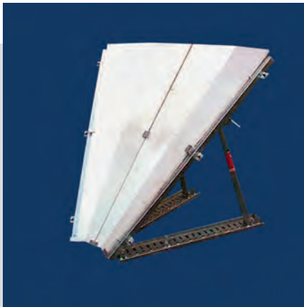
Innenecke mit Schutzplatten belegt. Die Platten liegen unten in den Halterungen der Böcke. Mittig und oben werden sie arretiert wie die Regelplatten.
