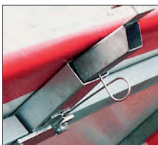
Oberer Plattenhalter in Hochstellung (zum Einbauen der Platten und Plane)
