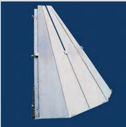
Außenecke mit Schutzplatten belegt. Die Platten liegen unten in den Halterungen der Böcke sowie in zusätzlichen Halterungen an den Aussteifungsrahmen. Mittig und oben werden sie arretiert wie die Regelplatten.
