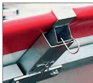
Oberer Plattenhalter in Verschlussstellung (Fixierung mit einer Feder)
