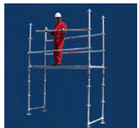
Rohrriegel 250 als Seitenschutz 0,50 m und 1,00 m über der Lauffläche montieren - fertig!
